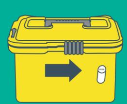
**2** Glissez le dispositif de verrouillage avant complètement vers la droite.
